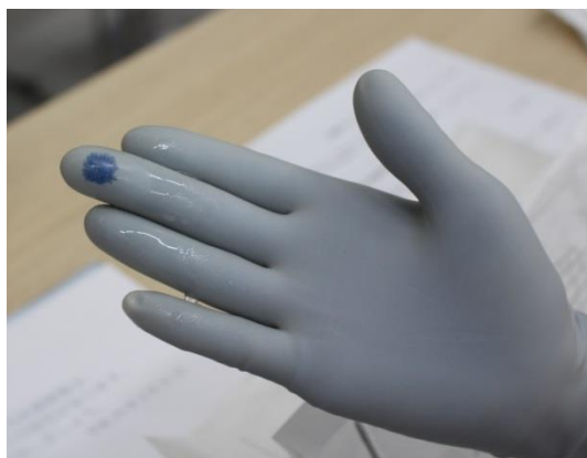
ピンホール部分を検知し、青く変色している様子
